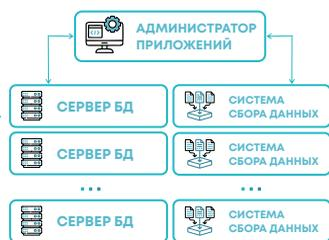
Модульная структура комплекса позволяет создать распределённую систему учёта, обработку данных с неограниченного количества приборов учёта.
