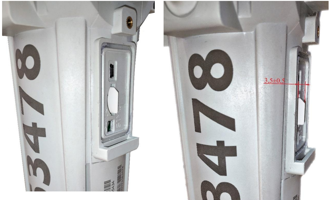
Рис. 4 – Правильное расположение SIM-карты после установки в измерительном блоке.
