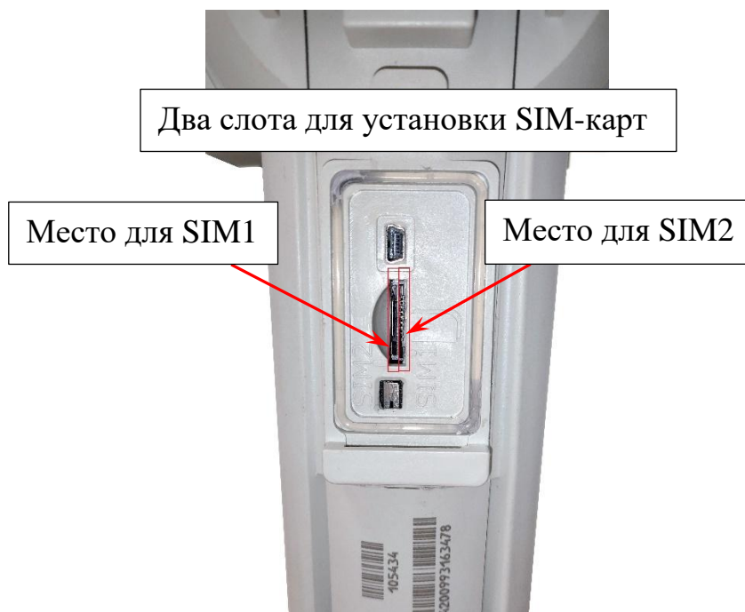
Рис. 2 – Измерительный блок с двумя слотами под SIM-карты во встроенном модуле связи.
