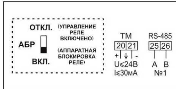
Рисунок Б.13 – Схема включения сигнальных цепей счетчиков в корпусах W37 непосредственного включения с аппаратной блокировкой встроенного реле управления нагрузкой, с одним интерфейсом RS-485, с телеметрическим выходом (TM)
