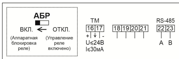
Рисунок Б.6 – Схема включения сигнальных цепей счетчиков в корпусах D37 непосредственного включения с интерфейсом RS-485, с телеметрическим выходом (ТМ), аппаратной блокировкой встроенного реле управления нагрузкой (с помощью микропереключателя)
