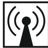
Рисунок 2.2 – Обозначение дополнительного датчика воздействия ВЧ поля на счетчик
