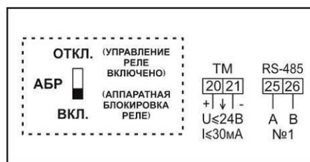
Рисунок Б.7 – Схема включения сигнальных цепей счетчиков в корпусах W37 непосредственного включения с аппаратной блокировкой встроенного реле управления нагрузкой, с одним интерфейсом RS-485, с телеметрическим выходом (ТМ)
