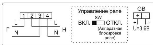
Рисунок Б.1 – Схема включения счетчиков в корпусах D17 с интерфейсом RS-485, с одним дискретным выходом, настроенным как телеметрический выход (TM), разъемом для подключения дополнительной батарейки (GB) и аппаратной блокировкой встроенного реле управления нагрузкой
