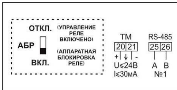
Рисунок Б.13 – Схема включения сигнальных цепей счетчиков в корпусах W37 непосредственного включения с аппаратной блокировкой встроенного реле управления нагрузкой, с одним интерфейсом RS-485, с телеметрическим выходом (ТМ)
