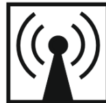
Рисунок 2.2 – Обозначение дополнительного датчика воздействия ВЧ поля на счетчик
