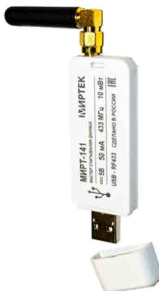
Рисунок 10 – USB модем МИРТ-141 для считывания данных по каналу RF433.
