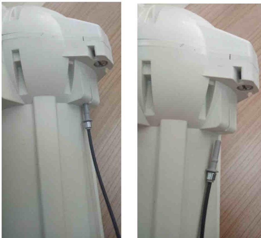
Рисунок 9 – Подключение внешнего дистанционного оптического кабеля для выполнения поверки.
