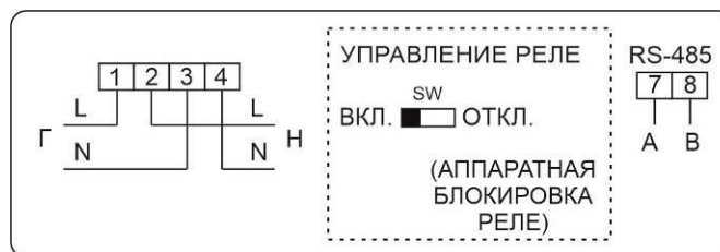
Рисунок Б.35 – Схема включения счетчиков в корпусах W9 с интерфейсом RS-485 и аппаратной блокировкой встроенного реле управления нагрузкой (с помощью микропереключателя)
