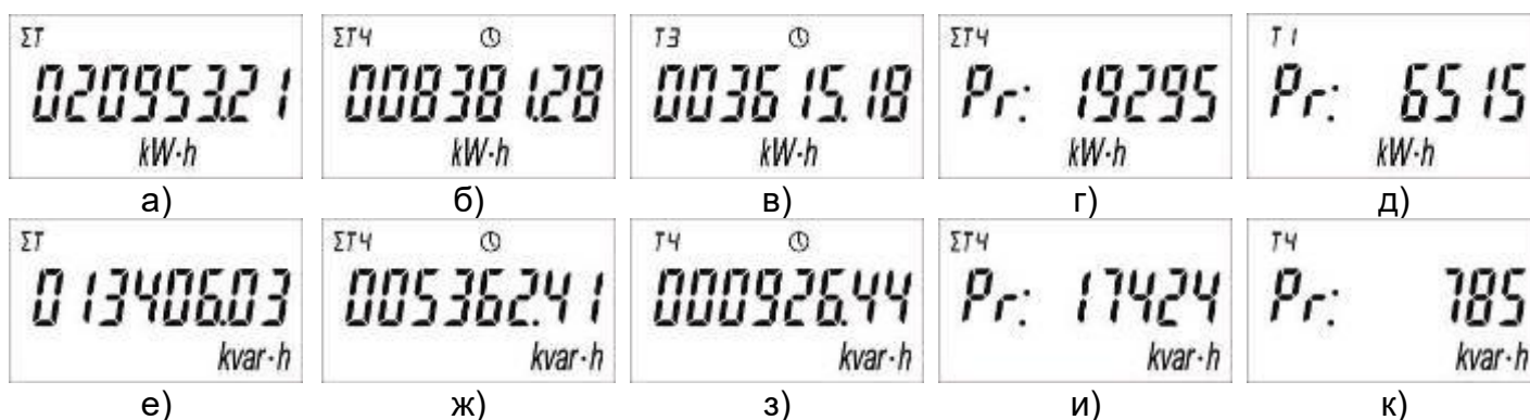
Рисунок Ж.4 – Программируемые режимы индикации счетчика
