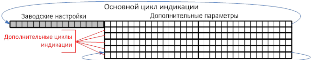
Рисунок 3.5 – Режимы циклической индикации счетчика с символами «A1Rx-xxx-Px-xxx-D»
