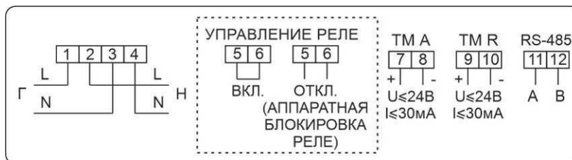
Рисунок Б.25 – Схема включения счетчиков в корпусах W3 с интерфейсом RS-485, с двумя (независимыми) дискретными выходами, настроенными как телеметрический выход активной энергии (TM A) и реактивной энергии (TM R) и аппаратной блокировкой встроенного реле управления нагрузкой (с помощью клеммника)
