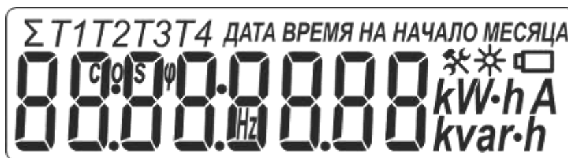
Рисунок 3.1 – Режим теста ЖКИ счетчика
