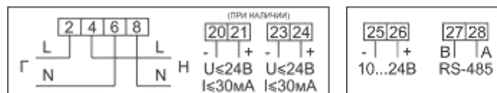
Рисунок Б.7 – Схема включения счетчиков МИРТЕК-12-АМ-D1-xxxx-RS485, МИРТЕК-12-АМ-D4-xxxx-RS485
