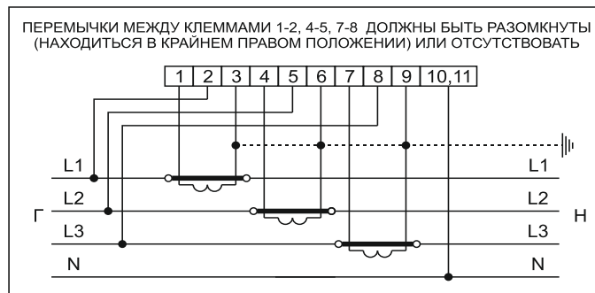
Рисунок Б.2 – Схема включения счетчиков в корпусах D33 трансформаторного включения через три трансформатора тока
