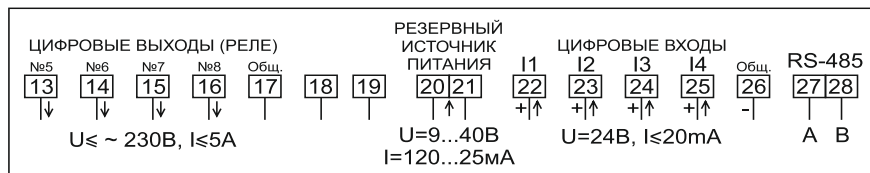
Рисунок Б.44 – Схема включения сигнальных цепей счетчиков в корпусе W32 с интерфейсом RS-485, с четырьмя дискретными выходами (с одним общим проводом) и с четырьмя дискретными входами (с одним общим проводом), с одним входом для подключения резервного источника питания в диапазоне от 9 до 40 В
