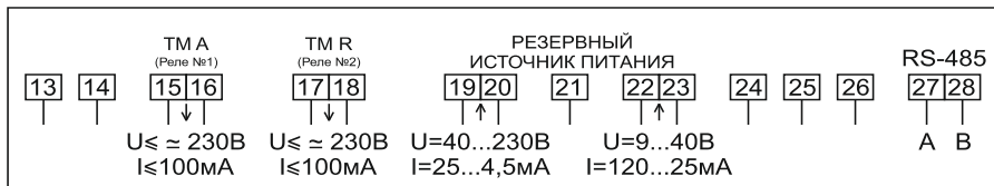
Рисунок Б.38 – Схема включения сигнальных цепей счетчиков в корпусе W32 с интерфейсом RS-485, с двумя (независимыми) дискретными выходами, с двумя входами для подключения резервного источника питания в диапазоне от 9 до 40 В и от 40 до 230 В (вариант 2)
