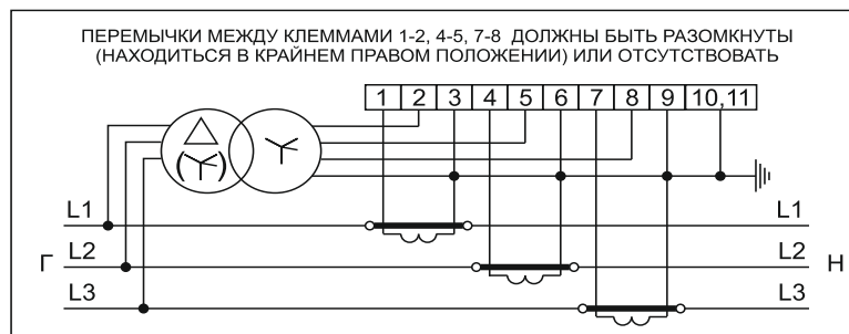
Рисунок Б.9 – Схема включения счетчиков в корпусах W31 трансформаторного включения через три трансформатора напряжения и три трансформатора тока
