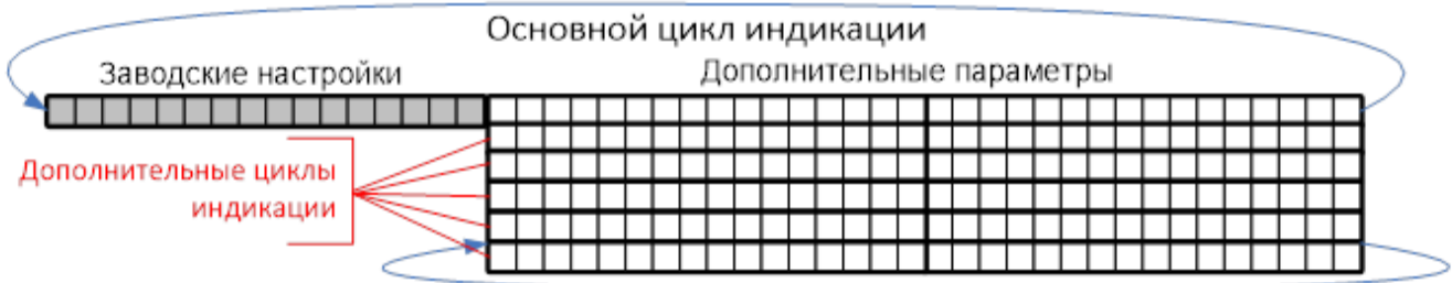
Рисунок 3.5 – Режимы циклической индикации счетчика с символами «A1Rx-xxx-Px-xxx-D»
