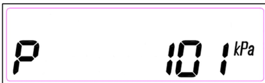
3.4.14 При длительном удержании кнопки происходит переключение на сервисные функции счетчика. Переключение функциональных режимов происходит последовательно, для выбора нужного режима требуется отпустить удерживаемую кнопку.
