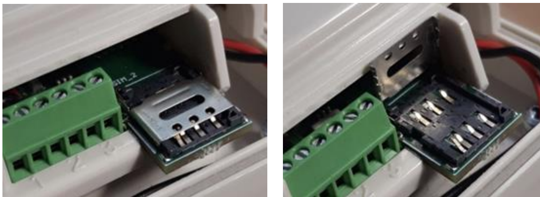
Рисунок 4 – Место установки SIM-карты
