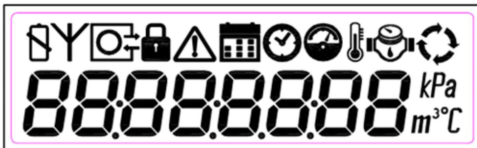
3.4.14.4 Принудительная передача по GSM. Происходит внеочередная попытка передачи данных по GSM, мигает значок антенны.
