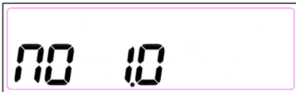
3.4.13.11 Адрес устройства. Отображает адрес необходимый для доступа по оптическому порту.
