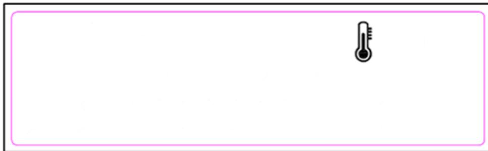
свидетельствует о неисправности встроенного датчика температуры.
