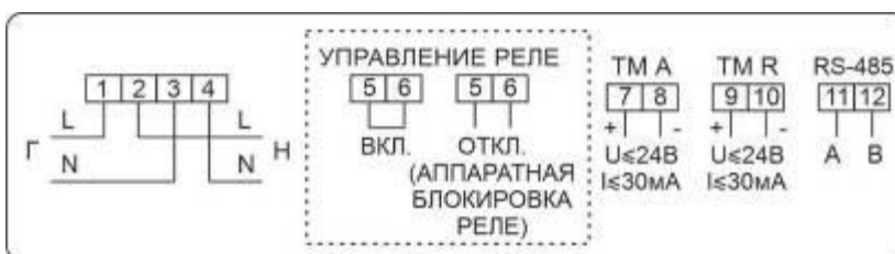
Рисунок Б.25 – Схема включения счетчиков в корпусах W3 с интерфейсом RS-485, с двумя (независимыми) дискретными выходами, настроенными как телеметрический выход активной энергии (ТМ А) и реактивной энергии (ТМ R) и аппаратной блокировкой встроенного реле управления нагрузкой (с помощью клеммника)
