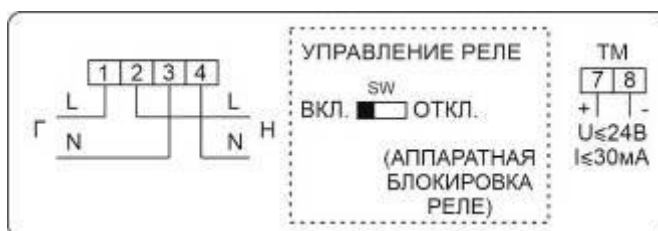
Рисунок Б.36 – Схема включения счетчиков в корпусах W9 с одним дискретным выходом, настроенным как телеметрический выход (ТМ) и аппаратной блокировкой встроенного реле управления нагрузкой (с помощью микропереключателя)
