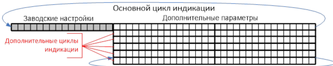
Рисунок 3.5 – Режимы циклической индикации счетчика с символами «A1Rx-xxx-Px-xxx-D»
