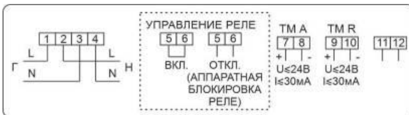
Рисунок Б.23 – Схема включения счетчиков в корпусах W3 с двумя (независимыми) дискретными выходами, настроенными как телеметрический выход активной энергии (ТМ А) и реактивной энергии (ТМ R) и аппаратной блокировкой встроенного реле управления нагрузкой (с помощью клеммника)
