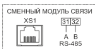
Рисунок Б.64 – Схема включения сигнальных цепей сменного модуля связи счетчиков в корпусах W32 с Ethernet-модулем с дополнительным интерфейсом RS485 для подключения дополнительных устройств
