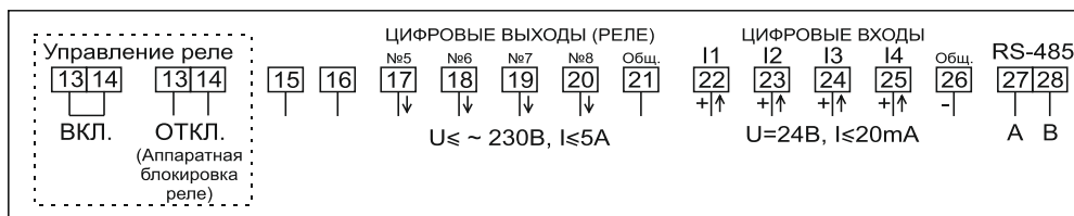
Рисунок Б.49 – Схема включения сигнальных цепей счетчиков в корпусе W32 непосредственного включения с интерфейсом RS-485, с четырьмя дискретными выходами (с одним общим проводом) и с четырьмя дискретными входами (с одним общим проводом), и аппаратной блокировкой встроенного реле управления нагрузкой (с помощью клеммника)
