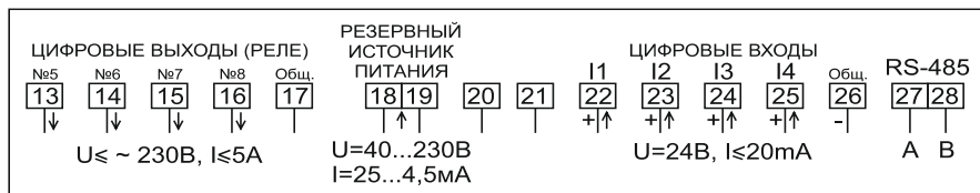
Рисунок Б.45 – Схема включения сигнальных цепей счетчиков в корпусе W32 с интерфейсом RS-485, с четырьмя дискретными выходами (с одним общим проводом) и с четырьмя дискретными входами (с одним общим проводом), с одним входом для подключения резервного источника питания в диапазоне от 40 до 230 В
