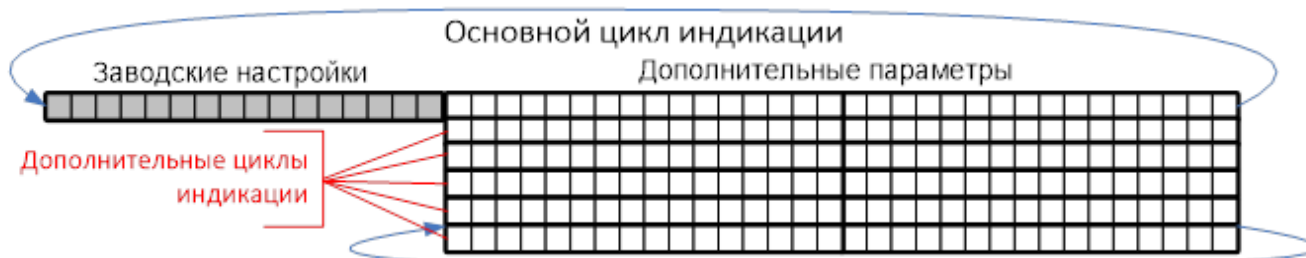
Рисунок 3.5 – Режимы циклической индикации счетчика с символами «A1Rx-xxx-Px-xxx-D»
