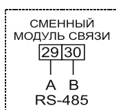
Рисунок Б.62 – Схема включения сигнальных цепей сменного модуля связи счетчиков в корпусах W32 с интерфейсом RS-485
