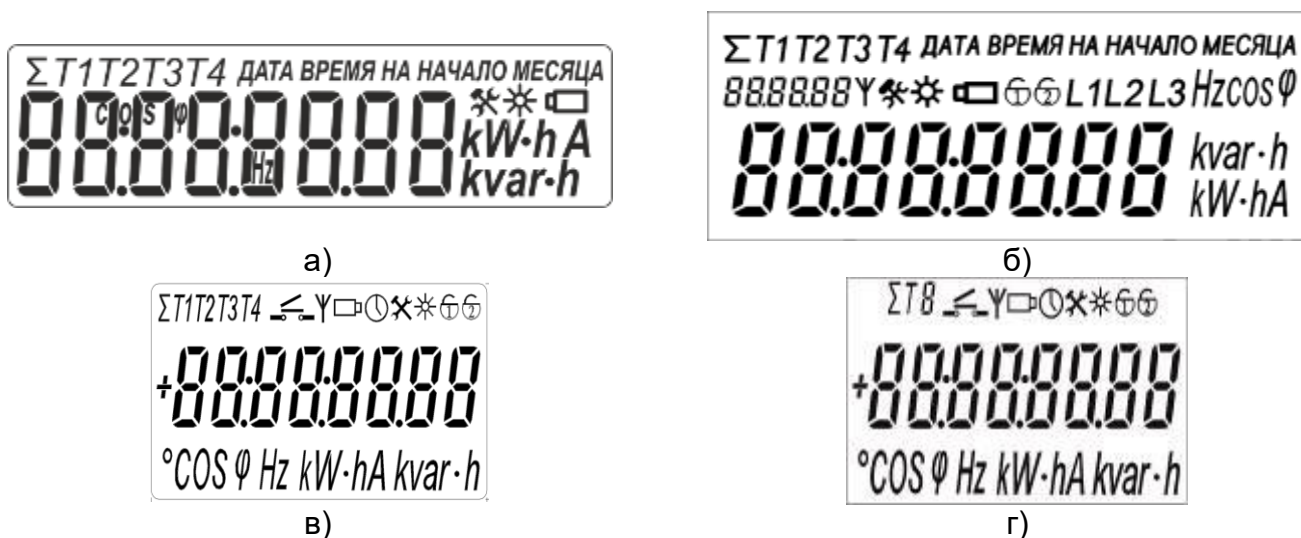
Рисунок 3.1 – Режим теста ЖКИ счетчика
